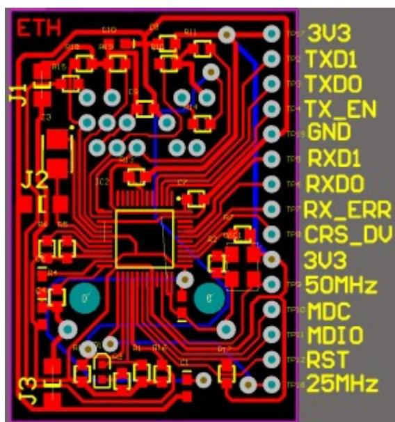
Po izdelavi tiskanine, to zvrtamo z 0,8mm svedrom za kontakte ethernet konektorja in dodamo dve 2mm luknji za montažo plastičnih zatičev konektorja. V skrajni sili lahko te zatiče preprosto odščipnemo.
