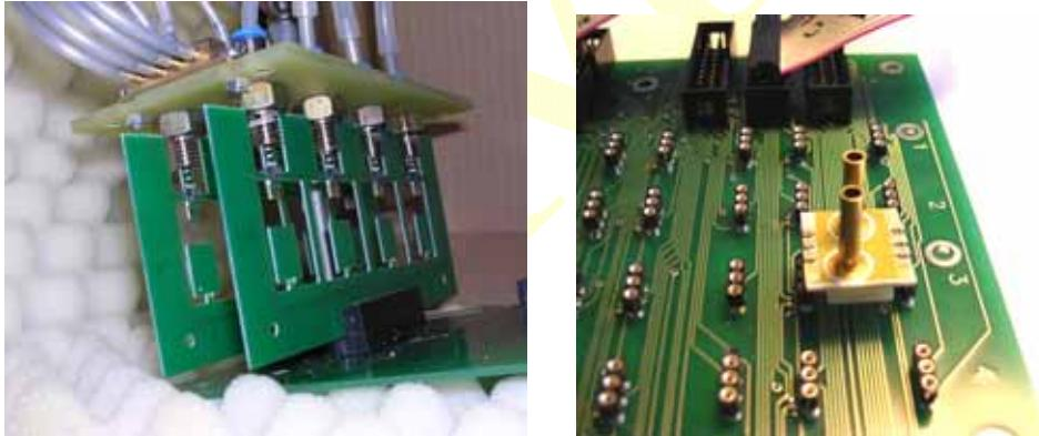
Slika 26: Primer kalibracijskih vmesnikov za različne vrste senzorjev
